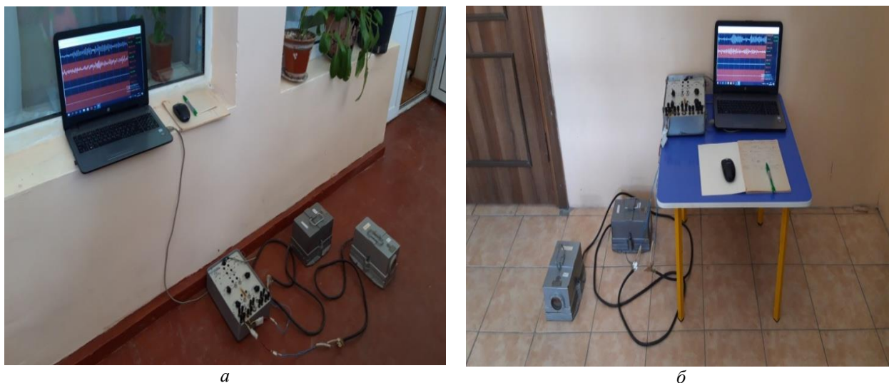
Рис.1. Момент регистрации микросейсмических колебаний зданий ДОУ №153: а – блок 1; б – блок 2
